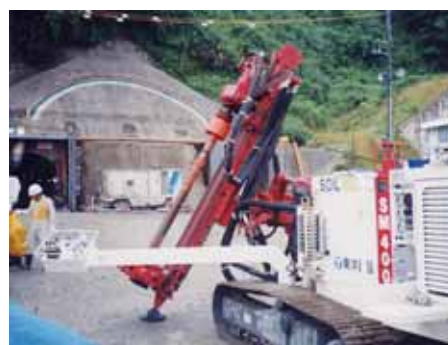
図-2.6.4 削孔機械 SM400-S
