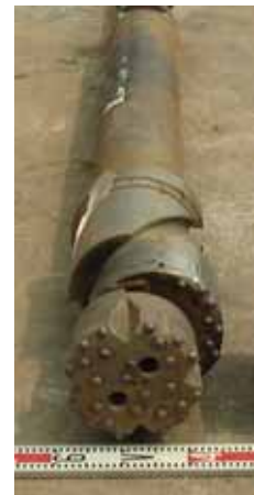
図-2.3.4 偏芯拡径型ビット
