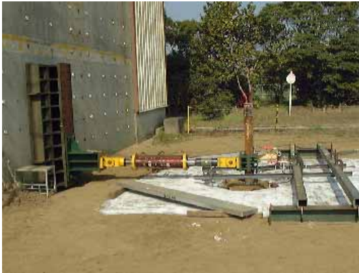
図-2.4.15 水平交番載荷試験状況
