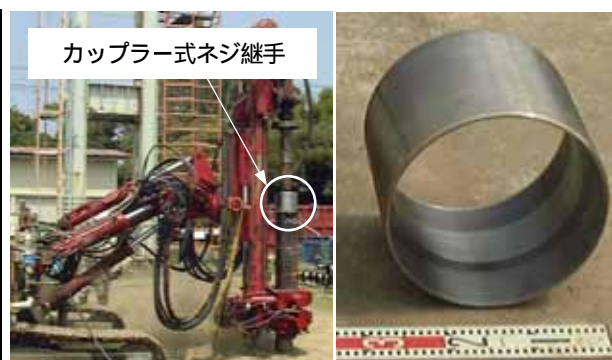
図-2.5.1 カップラー式ネジ継手の一例
