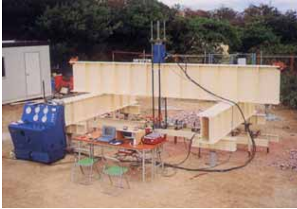
図-2.3.20 鉛直載荷試験状況 7)
