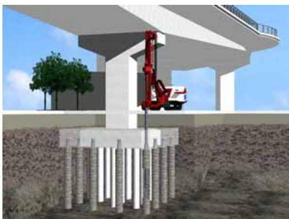
図-2.2.2 既設構造物基礎の補強増し杭 2) (STマイクロパイル タイプ )
