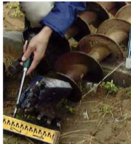
図-2.4.7 オーガー先端ビット例
