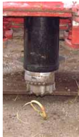
図-2.3.4 偏芯拡径型ビット
