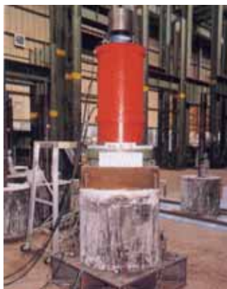
図-2.5.3 節突起付き鋼管の付着性能試験
