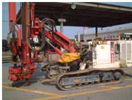
図-2.6.2 削孔機械 SM-400
