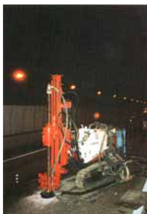
図-2.6.3 削孔機械 SM-103HD
