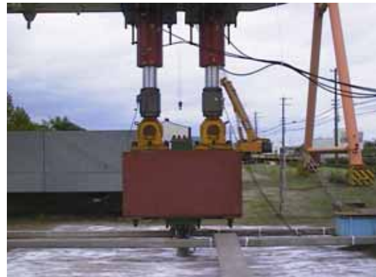
図-2.4.14 鉛直引抜き載荷試験状況
