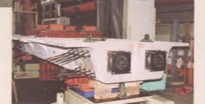
実物大載荷試験(端部)
