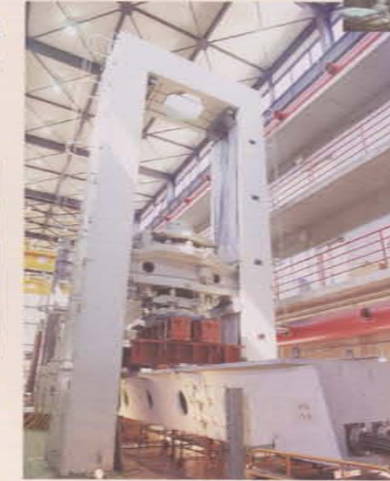
実物大載荷試験(一般部)
