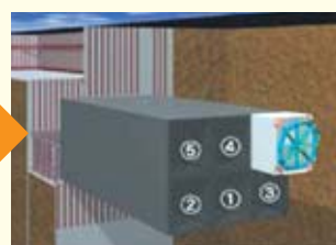
④ 掘進を完了します。 トンネルの土工事が完了です。
