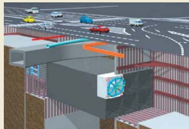
埋設物下の鉄道構造物
