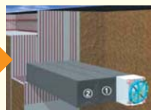
② 基準トンネルをガイドにして隣接トンネルを施工します。
