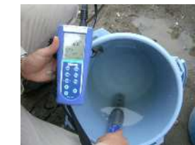
【ろ過水濁度測定】
