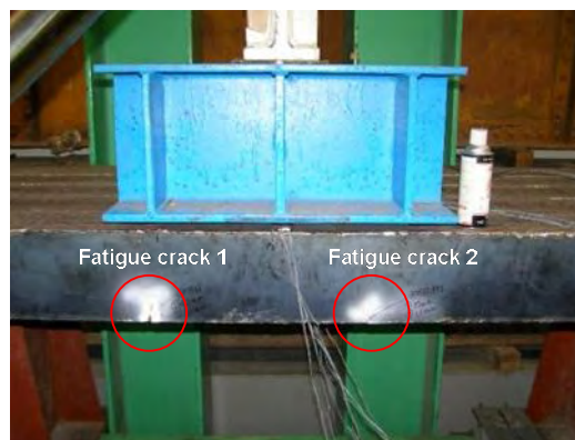
写真-6 疲労亀裂発生状況
