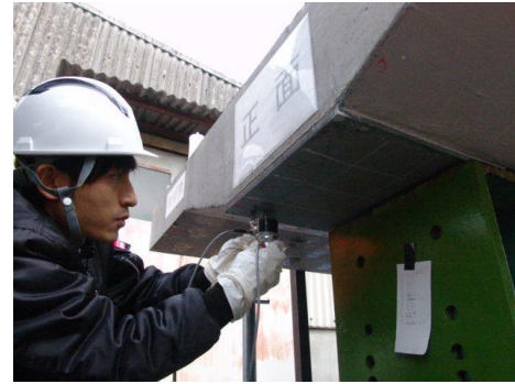
鉄板貼りのコンクリートの探査
