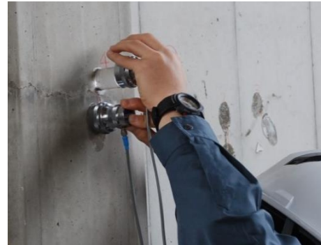
鉄板貼りのコンクリートの探査
