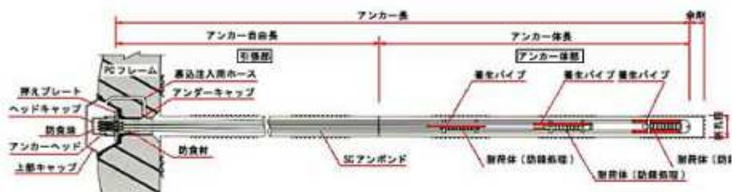
(荷重分散型アンカーの形状図)
