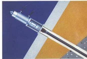
5. 緊張 グラウトが所定の強度に達した所で、緊張作業を行います。プレート背面防食のために、ストップパースを取付け、緊張力とアンカー頭部の変位を確認しながら緊張作業を行います。
