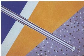
1. 削孔 所定の角度で定着地盤まで削孔します。
