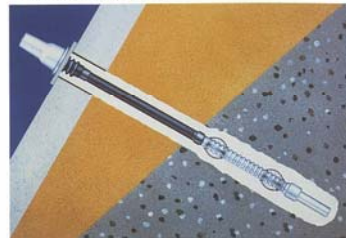
6. 頭部処理・完成 定着されたアンカー頭部にアンカーキャップを取付け、防錆処理を行ない作業が完了します。
