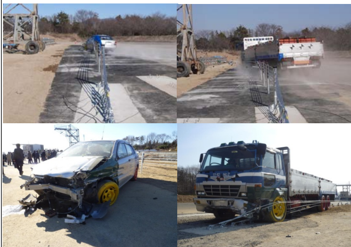
写真-1 衝突試験と衝突後の車両 (左側:乗用車、右側:大型車)
