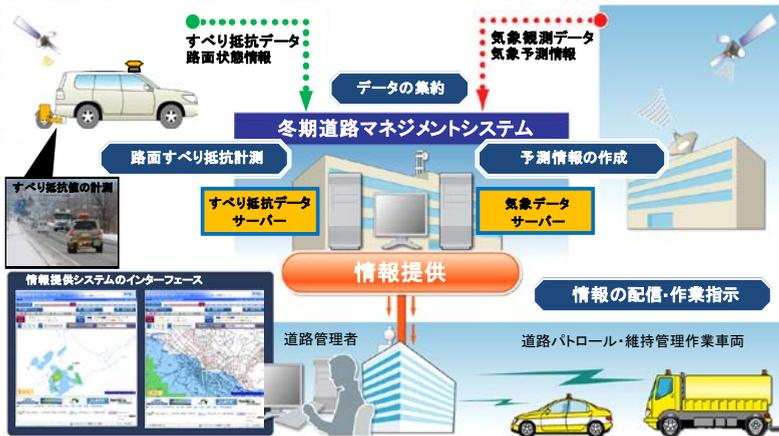
図2 冬期道路マネジメントシステムの概要図
