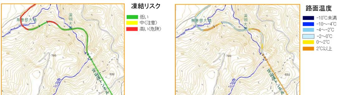
図4 路面凍結情報表示例
