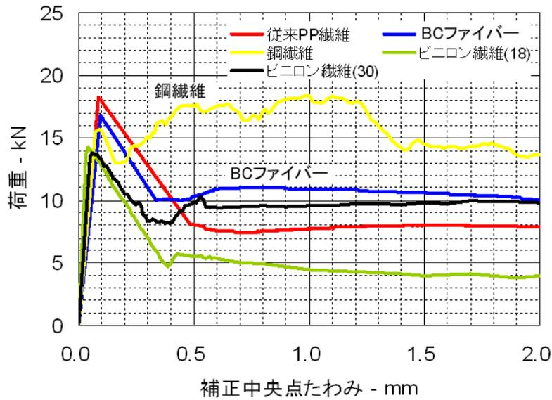
図-2 各種繊維補強モルタルの曲げタフネス試験
