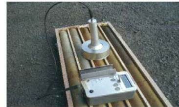
10cm間隔で測定するコアγ線探査の状況
