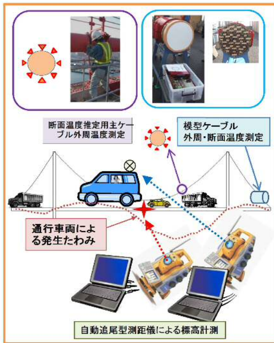
図-3 MAT計測法の概要
