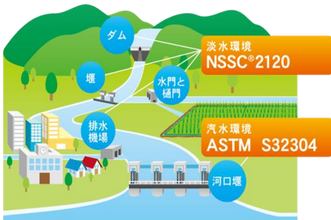
図2. 省合金二相ステンレス鋼の適用提案
