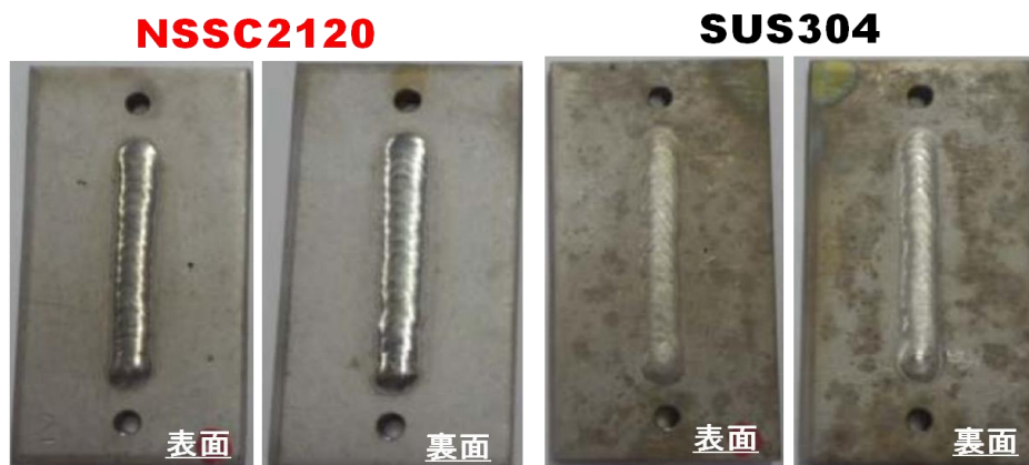
図1. 海岸暴露試験による耐食性比較
