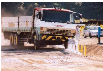
Gr・L型擁壁H1500 実車衝突試験
