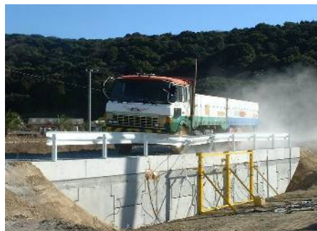
Gr・L型擁壁H500 実車衝突試験
