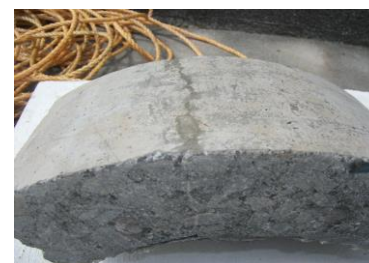
●電柱外面から見たクラック修復状況(高知県宿毛小学校横)
