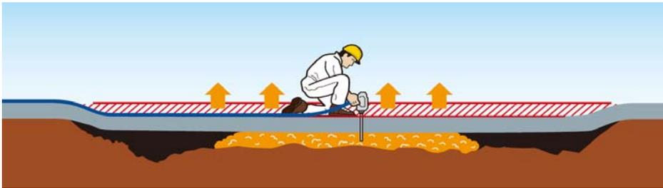
2. 土木 踏掛版下の空洞充填工事例(モルタル充填工法との比較)
