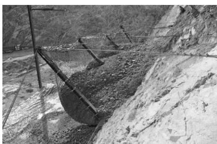
衝撃力200kN/m<sup>2</sup>、崩壊土砂150m<sup>3</sup>の90%以上の捕捉を確認
