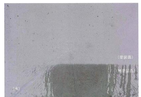
防水性能確認写真
