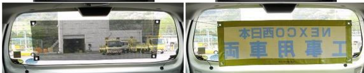
工事用車両標示幕 視認性比較
