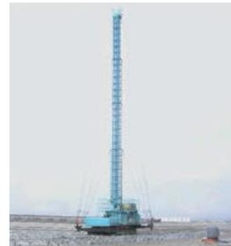
写真-2.3 鉛直ドレン打設機
