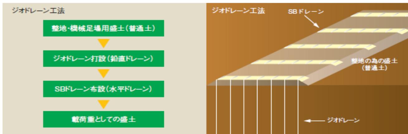
図-1 ジオドレン工法施工フロー
