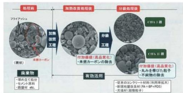
高品質フライアッシュの製造工程と電子顕微鏡（SEM）写真
