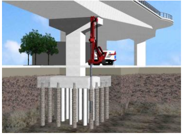
既設構造物基礎の補強増し杭
