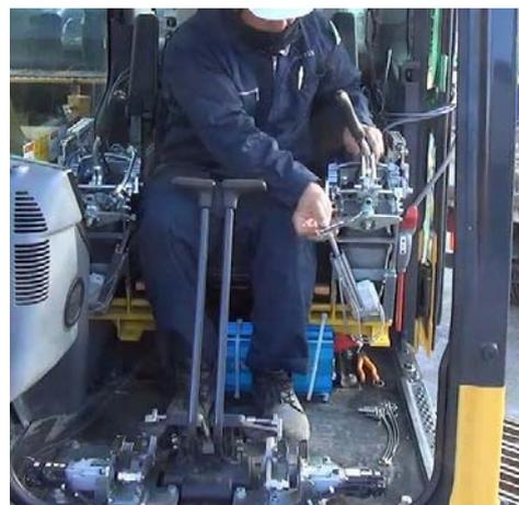
写真-2 搭乗操作への切替状況
