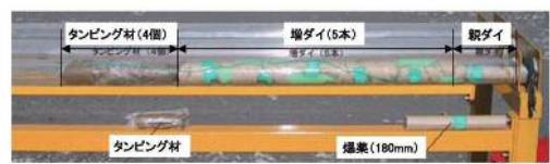
模擬の爆薬による遠隔装填システムによる密充填状況
