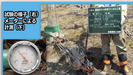
立木アンカーの引張試験
