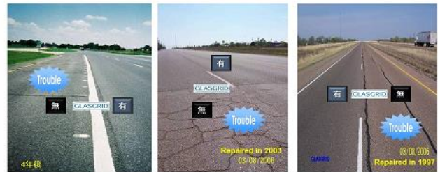
【GlasGrid®施工有】及び【補強材無し】を比較実験(米国にてモニタリング)
