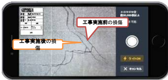
前回の写真がオーバーレイ表示され亀裂が比較でき
