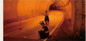
写真 1 照度計測定状況
