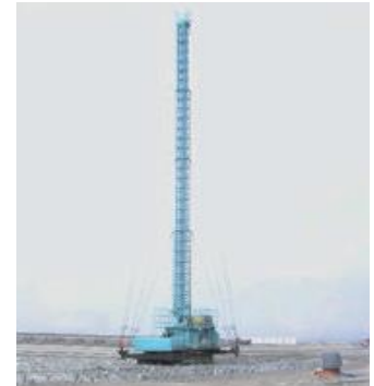
写真-2.3 鉛直ドレーン打設機
