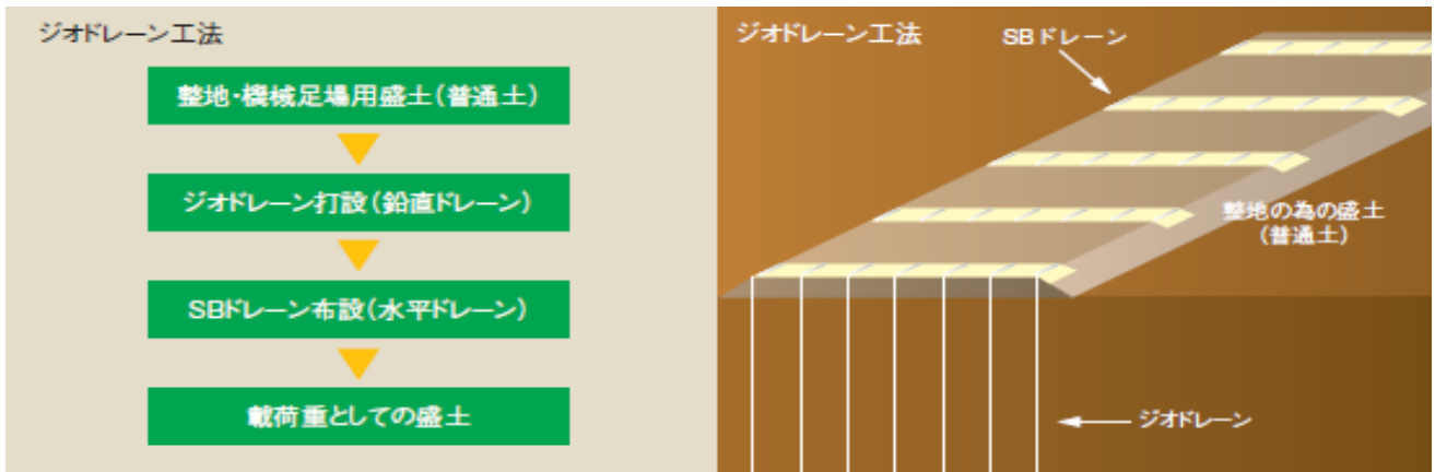
図-1 ジオドレーン工法施工フロー
