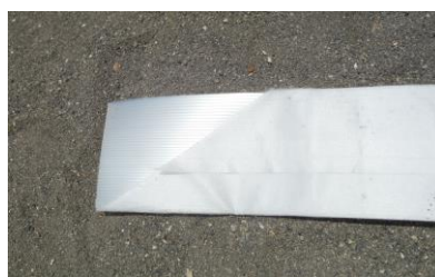
写真-1.2 鉛直ドレーン(生分解性)
