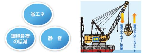
クラブ巻き下げ時に発生するエネルギーを蓄え、クラブ巻き上げ時に利用します。燃料消費量を25%～30%低減できるとともにCO<sub>2</sub>などの排出ガスも大幅に削減できます。
