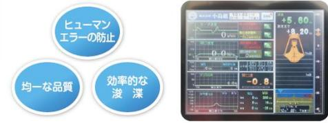
運転席に設置されたタッチパネルで作業状況に応じた数値等を入力するだけで自動制御により掘削・旋回・積込みを行えるよう設定されています。
