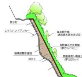
擁壁タイプ(崩壊部復旧タイプ)
