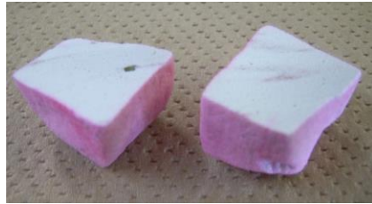
非吸水性ミラクルソルのカット断面 (骨材内部へ水分が浸透しない)
