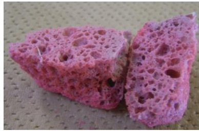
吸水性ミラクルソルのカット断面 (吸水率100%以上)
