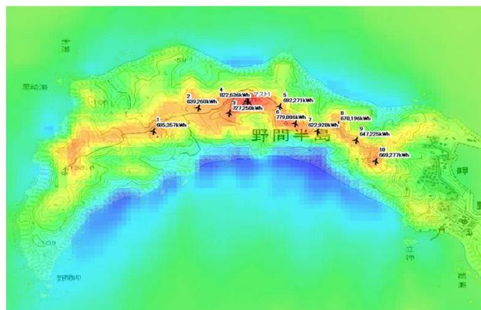
構築した詳細標高データを基に16風向別の風況シミュレーションを実施し、任意の高さの局所風況マップの作成
