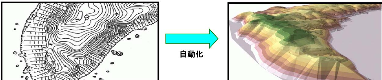
紙地図やDXF形式CADデータからの高解像度の標高データ構築技術の開発により、風車近傍のわずかな地形起伏に起因した地形乱流(風の乱れ)の影響を忠実に再現
