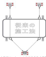
あと施工アンカーにより支持金物を設置し、ワイ ヤーを 接続することにより、落下対策を行うことが できます。
