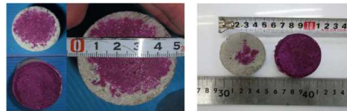
1年後 (左上・右): モルタル (左):モルタル (右):ShieM-CS (左下): ShieM-CS
