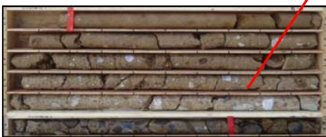
写真-3 改良体の攪拌翼取り込み状況
