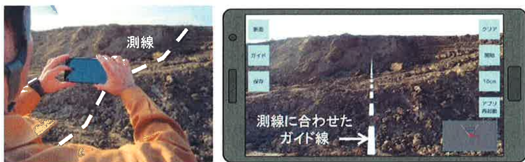
図2 断面測量時のARIによるガイド線表示
