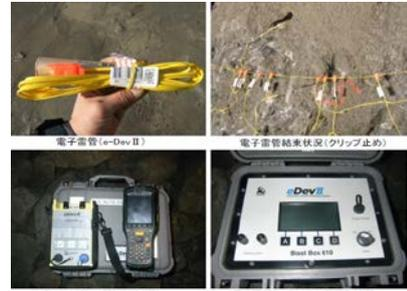
電子雷管(e-Dev II)      電子雷管結束状況(クリップ止め)
