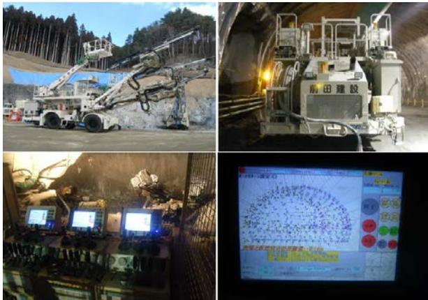
図-4 ドリルジャンボ(トンネルナビゲーションシステム搭載)
