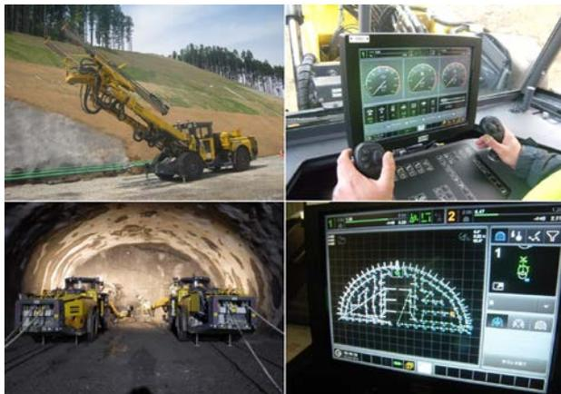
図-6 ドリルジャンボ(全自動制御コンピュータジャンボ)
