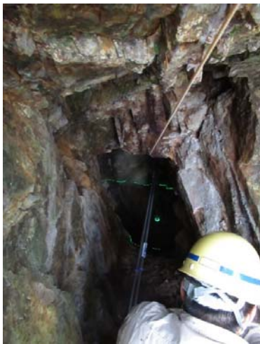
図-5 リングビームスキャナーによる測定事例(空洞調査)
