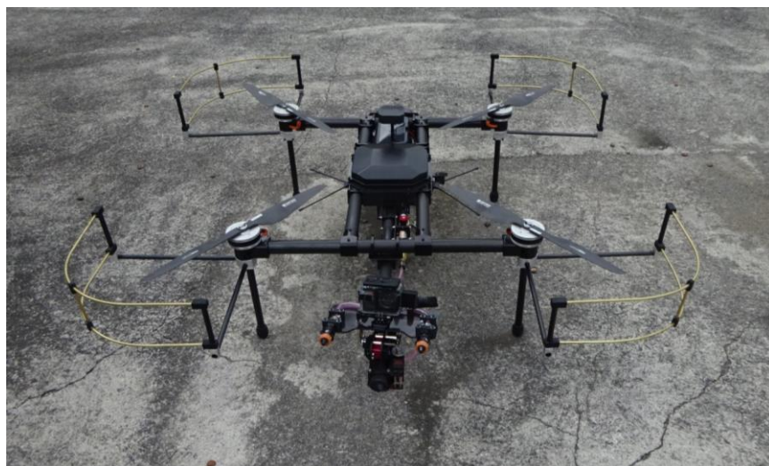
図3:新型吹付ドローン「SCSD-004 Ser α」
