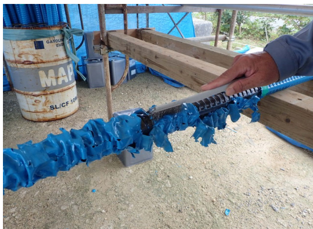
浸漬24時間後。剥がれた塗装を除去
