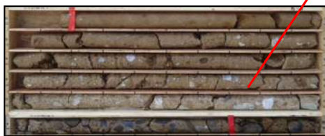
写真-3 改良体の碟取り込み状況
