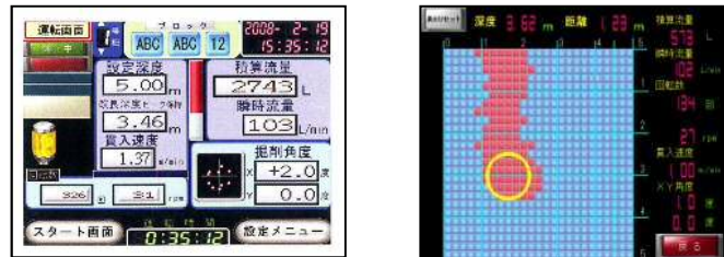
図-4 施工管理装置表示例
