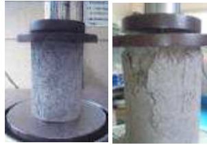
一軸圧縮強度試験 1.2MPa以上
