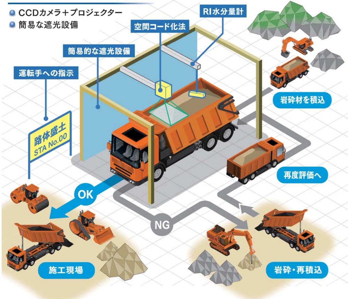
空間コード化法を用いた粒径判定システム
