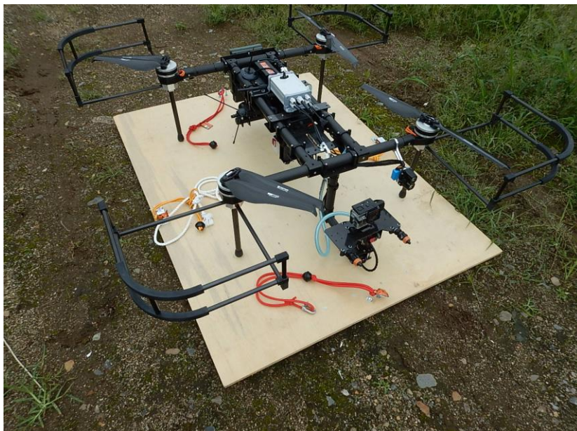
図3:新型吹付ドローン「SCSD-004 Ser α」
