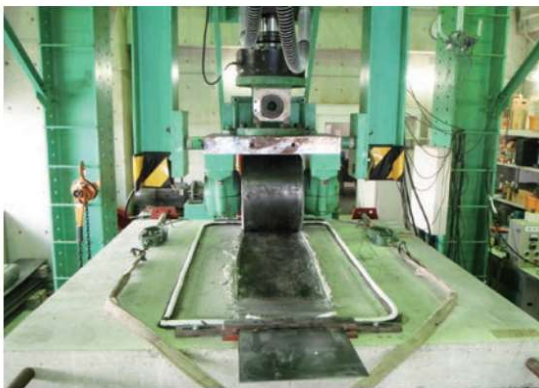
動的評価(輪荷重走行試験:日本大学生産工学部)
