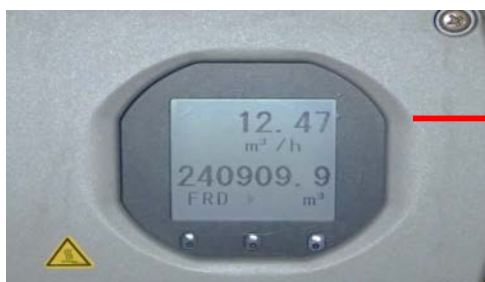
図7: 洗浄前後流量比較例(12.47m³/h→16.02m³/hに回復)
